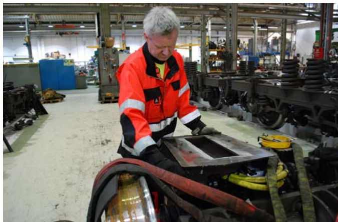
Jomar Aspås trives i CargoNet på Marienborg. Her reviderer han hjulgangen på en Di8.
